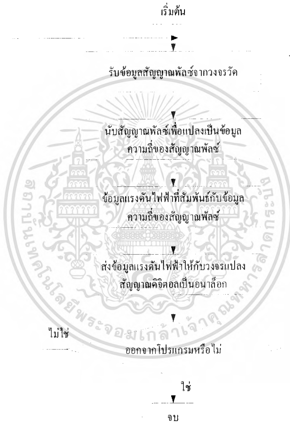
รูปที่ 3.5 ลำดับขั้นตอนการทำงานของไมโครคอนโทรลเลอร์ภาคส่ง
