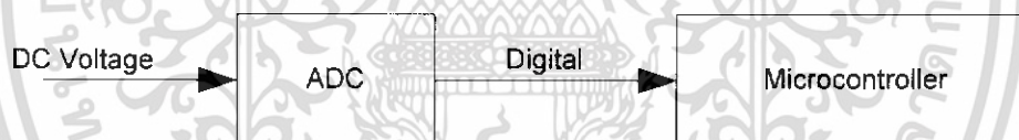
รูปที่ 3.12 Block Diagram การแปลงสัญญาณอนาลอกให้เป็นสัญญาณดิจิทัล
