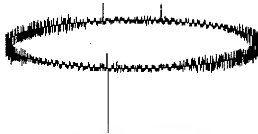
รูปที่ 4.75 PD บนรูปคลื่นอิลิปส์ ที่แรงดัน 15.65 kV ค่าดีสชาร์จ 11.22 pC ที่มุม 70, 110, 290 องศา
