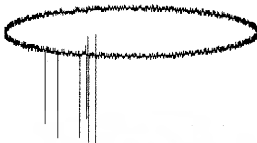
รูปที่ 4.20 PD บนรูปคลื่นอิลิปส์ ที่แรงดัน 4.81 kV ค่าดิสชาร์จ 67.58 pC ที่มุม 300-330 องศา
