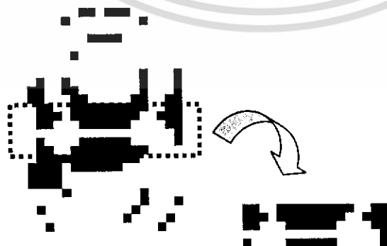
รูปที่ 3.23 แสดงถึงการนำภาพที่ได้จากการทำ Fully Pattern Matching มาทำ Partial Pattern Matching ต่อ ในกรณีที่ผ่านกรณีในรูปที่ 3.21 และ 3.22
