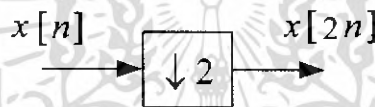
รูปที่ 3.8 บล็อกไดอะแกรมของวงจรสุ่มค่าตัวอย่าง
