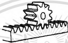
(จ) ฟันเขียงและเฟืองวาง (Pinion and rack)
