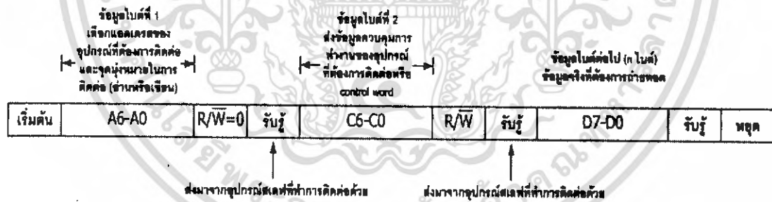
รูปที่ 2.49 รูปแบบของข้อมูลอนุกรมที่ใช้ติดต่อกับอุปกรณ์บัส I2C เมื่อใช้การอ้างถึงแบบ 7 บิต
