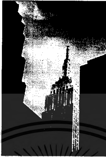
รูปที่ 5.88 แสดงรูปจากการทดลองที่ค่า E_b/N_0 เท่ากับ 5.0 ซึ่งได้ค่า BER เท่ากับ 0.0
