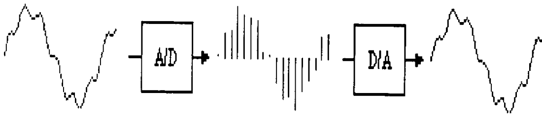
รูปที่ 2.6 แสดงการแปลงสัญญาณที่ต่อเนื่องมาเป็นสัญญาณที่ดิจิทัลโดย A/D และทำการแปลงกลับเป็นสัญญาณอนาล็อกโดยใช้ D/A
