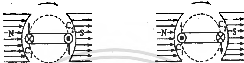
(ก) ทิศทางแรงเคลื่อนไฟฟ้ากลับของอาร์มาเจอร์ (ข) ทิศทางกระแสของอาร์มาเจอร์
