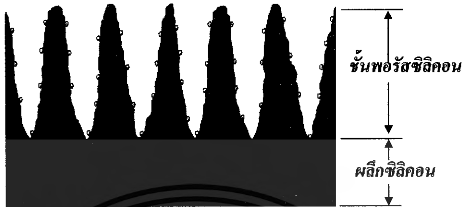
รูปที่ 3.6 มีการไหลของไอแอลกอฮอล์ ทำให้เริ่มมีโมเลกุลของไอแอลกอฮอล์มาจับตัวกันที่พื้นผิวของรูพรุน
