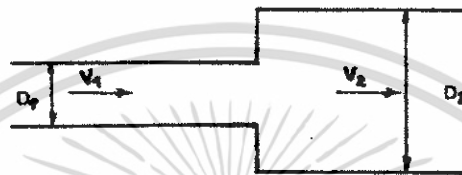
ภาพที่ 6 การเปลี่ยนแปลงขนาดท่อแบบกะทันหัน
