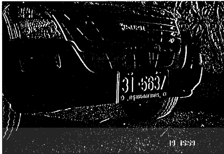
รูปที่ 3.6 ภาพที่ผ่านจากกระบวนการ Sobel Operator
