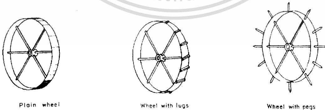
รูปที่ 2.10 ชนิดของล้อขับเคลื่อนเครื่องปลูกพืชแบบต่างๆ
