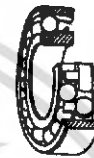
ตลับลูกปืนแบบลูกปืนลูกปืนกลมปรับตัวได้แถวคู่
