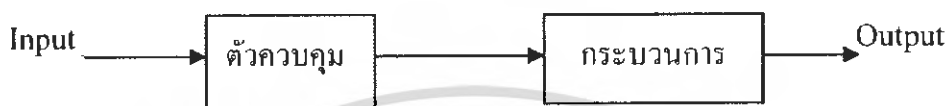
รูปที่ 2.10 บล็อกไดอะแกรมของระบบควบคุมแบบเปิด
