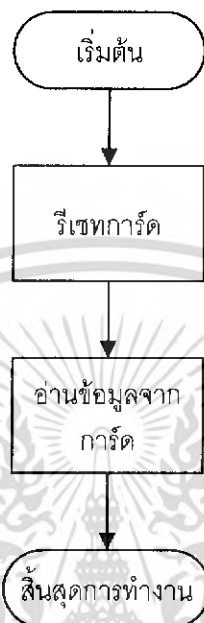
รูปที่ 3.7 แผนผังการทำงานของโปรแกรมกระบวนการอ่านข้อมูลภายในบัตรสมาชิก
