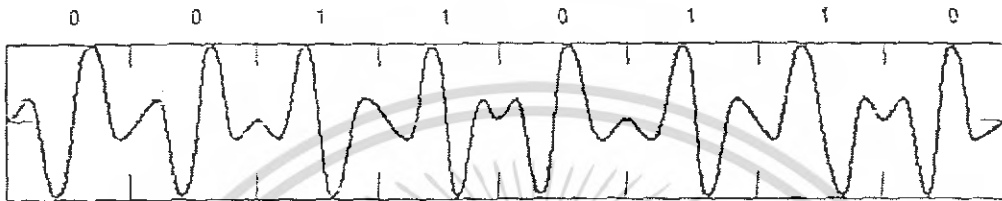
รูปที่ 2.11 สัญญาณที่ผ่านการมอดูเลตแบบสองเฟส
