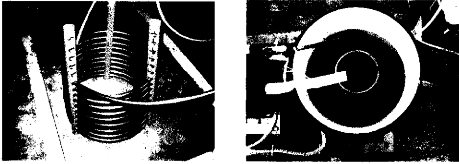
รูปที่ 3.12 Evaporator ที่ทำมาจากท่อทองแดง
