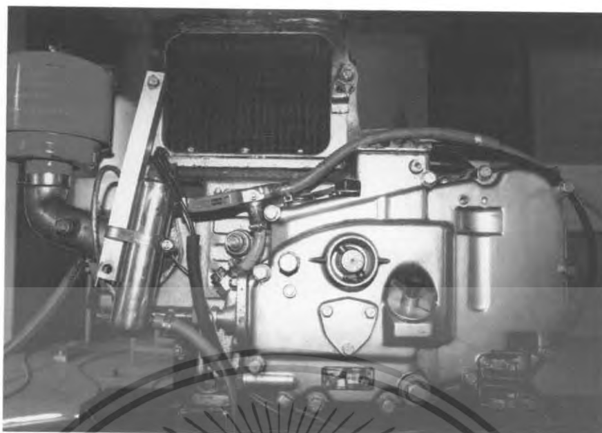
รูปที่ 4-14 การติดตั้งชุดอุ่นน้ำมันก่อนเข้าปั๊มหัวฉีด
