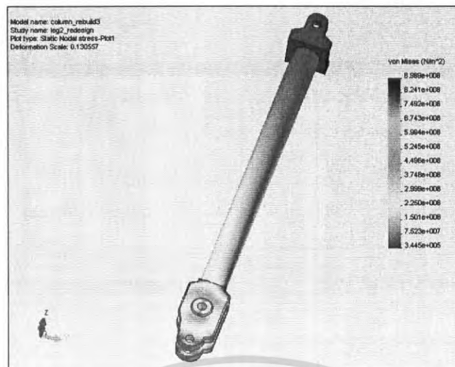
รูปที่ 4-17 แสดงการวิเคราะห์ความแข็งแรงชิ้นส่วนที่ 2 เมื่อปรับปรุงรูปร่าง
