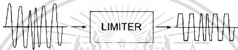
รูปที่ 2.13 วงจรลิมิตเตอร์จะขจัดนอยส์และการเปลี่ยนแปลงทางแอมพลิจูดของสัญญาณ FM
