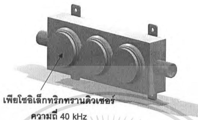
ภาพที่ 3.8 แสดงการติดตั้งเพียโซอิเล็กทริกขนาดความถี่ 40 kHz
