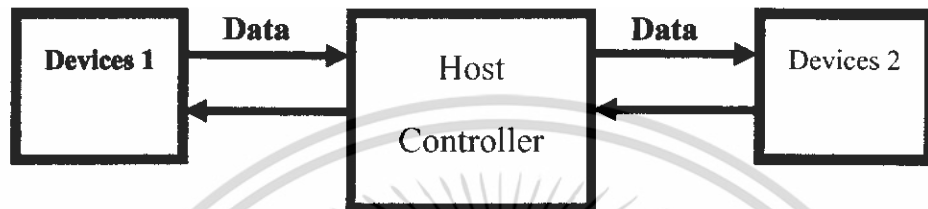
รูปที่ 4.1 แสดงลักษณะการเชื่อมต่อกันระหว่างอุปกรณ์ต่อพ่วงกับโฮตคอนโทรลเลอร์ที่ออกแบบ
