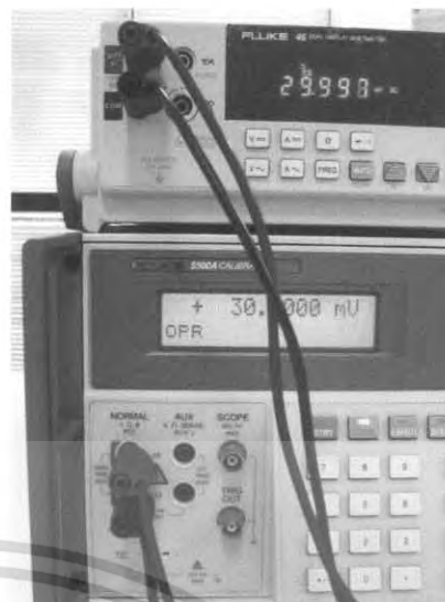
(ข) ฟังก์ชัน DC Voltage
