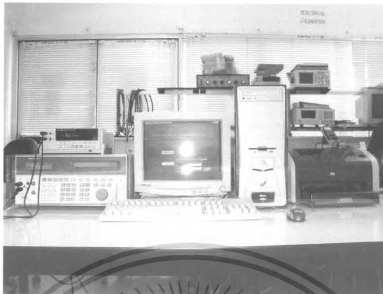
ภาพที่ 5.9 แสดงการเชื่อมต่ออุปกรณ์ทั้งหมดสำหรับการสอบเทียบดิจิทัลมิเตอร์
