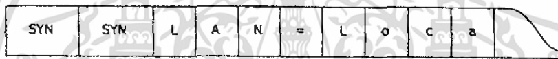
(b) การใช้อักขระ SYN 2 ตัวนำหน้าบล็อกรหัสของข้อมูล ที่ส่งผ่านในระบบเชิงไครนัล
