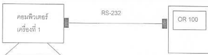
รูปที่ 4.2 แสดงการต่อ RS-232 ของคอมพิวเตอร์กับ OR-100
