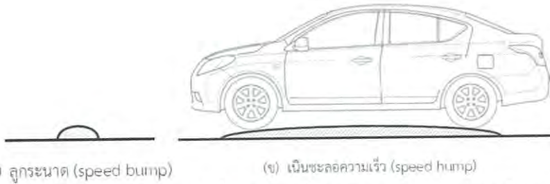
รูปที่ 2.8 ประเภทของสันชะลอความเร็วที่พบได้โดยทั่วไป (ก) ลูกกระพรวน (ข) เนินชะลอความเร็ว ที่มา : มยพ. 2301-56: มาตรฐานการก่อสร้างสันชะลอความเร็ว
