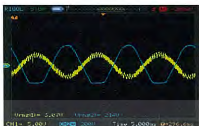
รูปที่ 4.3 การทำงานของแบบจำลองกังหันลมที่ความเร็วลม 7 m/s (Yel=5V/div,Blu=200V/div)
