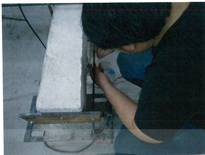
รูปที่ 3.10 การติดตั้ง Strain gauge ที่ลวดอัดแรง
