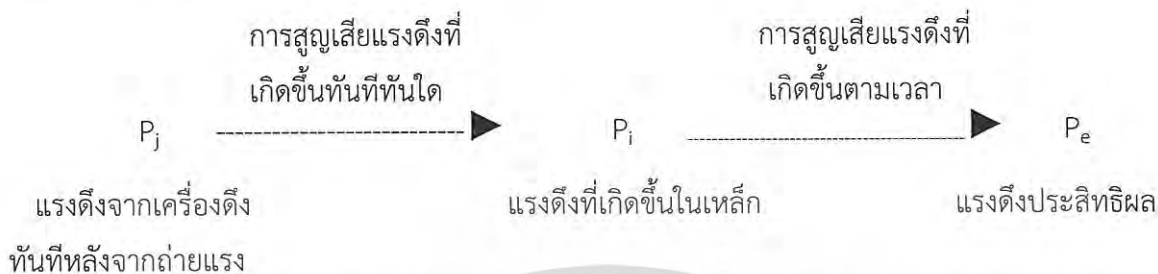
รูปที่ 2.8 การเสื่อมลดของแรงดึงในเหล็กเสริมอัดแรง [ดร.นเรศ พันธราธร, (1)]
