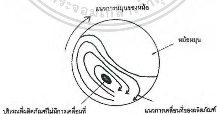
รูปที่ 2.6 บริเวณที่ผลิตภัณฑ์ไม่เกิดการเคลื่อนที่ (Dead zone) ภายในหม้อหมุน ที่มา: สุวรรณ (2543)
