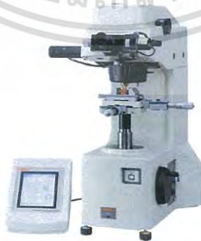
รูปที่ 3.7 เครื่องทดสอบความแข็ง Mitutoyo รุ่น HM-113
