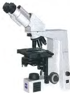
รูปที่ 3.10 กล้องจุลทรรศน์แบบแสง (Optical Microscope) ยี่ห้อ Zeiss รุ่น Axiolab
