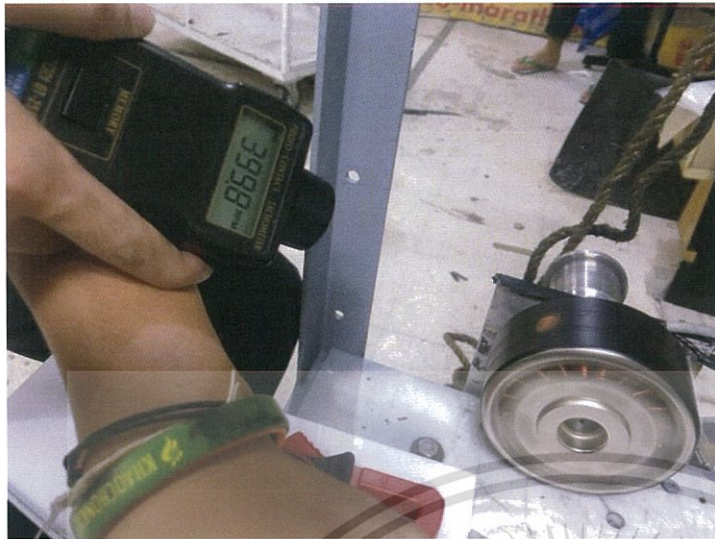
วัดความเร็วรอบมอเตอร์และแรงดันขาออกในสาย ที่ความเร็ว 400 rpm
