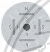
รูปที่ 2.2 โครงสร้างของโรเตอร์แม่เหล็กถาวรภายในแบบ Interior
