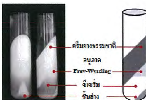
รูปที่ 2.2 การแยกชั้นของน้ำยาสดหลังจากผ่านกระบวนการหมุนเหวี่ยง [11]
