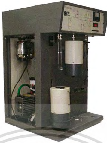
รูปที่ 3.6 เครื่องวิเคราะห์พื้นที่ผิวตามวิธีของ BET (Brunauer-Emmett-Teller Analyzer)
