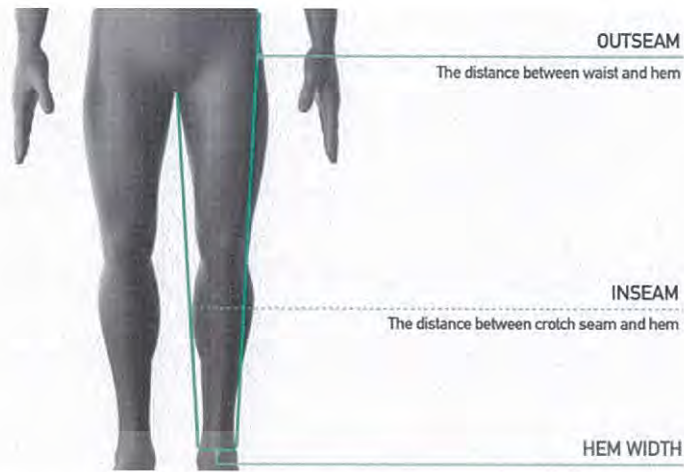
รูปที่ 3.16 การวัดค่าสัดส่วนจากพารามิเตอร์ทางด้านนอกและทางด้านใน
