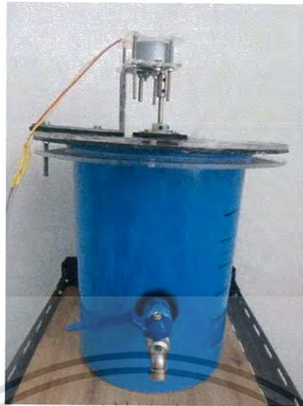
รูปที่ 3.3 แสดงถังหมักไร้ออกซิเจนแบบแบชขนาด 8 ลิตร
