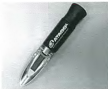
รูปที่ 3.8 รีแฟคโตมิเตอร์ที่ใช้ในการวัดค่าความเข้มข้นสารละลายน้ำตาล
