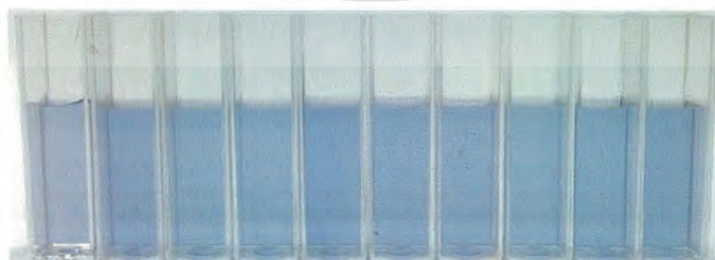
รูปที่ 4.17 ภาพสีของสารละลายอนุภาคเงินรูปร่างสามเหลี่ยมระดับนาโนที่มีตัวรบกวน Glutathione, \text{CaSO}_4 , \text{KNO}_3 , \text{NaNO}_3 , Uric acid, Glucose, Sucrose, Ascorbic acid, \text{MgSO}_4 และ \text{FeSO}_4 ความเข้มข้น 0.7 ppm
