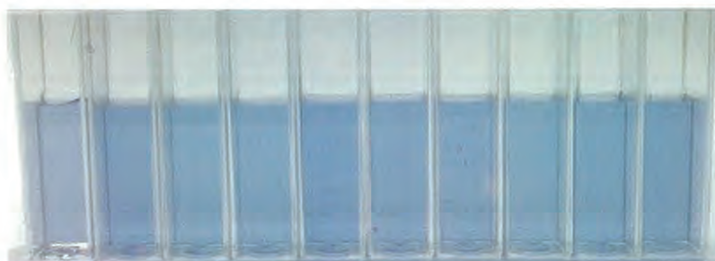
รูปที่ 4.18 ภาพสีของสารละลายอนุภาคเงินรูปร่างสามเหลี่ยมระดับนาโนที่มีตัวรบกวน Glutathione, \text{CaSO}_4 , \text{KNO}_3 , \text{NaNO}_3 , Uric acid, Glucose, Sucrose, Ascorbic acid, \text{MgSO}_4 และ \text{FeSO}_4 ความเข้มข้น 1.0 ppm
