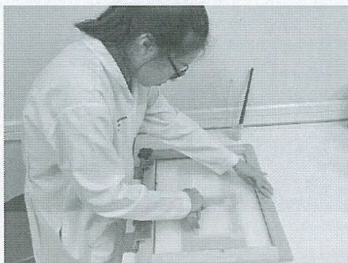
ภาพที่ 3.7 การปาดสูตรวัสดุรองพื้นลงบนผ้าดิบผ่านบล็อกสกรีน
