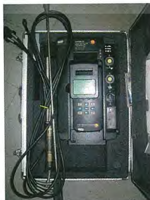
รูปที่ 4.11 เครื่องวิเคราะห์แก๊สไอเสีย TESTO 350M XL
