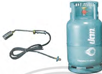
รูปที่ 4.9 ชุดอุปกรณ์ให้ความร้อนเบื้องต้น
