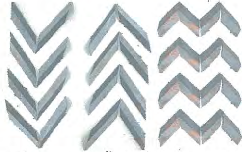
รูปที่ 2.20 การติดตั้งครีบที่ใช้ในทดลอง [14]
