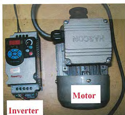
รูปที่ 4.8 ชุด Motor และ Inverter ควบคุมปริมาณการป้อนเชื้อเพลิงแกลบ
