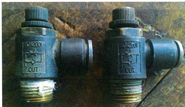
รูปที่ 7 วาล์วควบคุมอัตราการไหล
