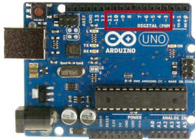
รูปที่ 2.9 ช่องสัญญาณที่สามารถสร้างสัญญาณอนาล็อกแบบ PWM ในไมโครคอนโทรลเลอร์
