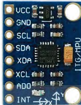
รูปที่ 3.2 เซ็นเซอร์วัดความเร่ง ( MPU-6050)
