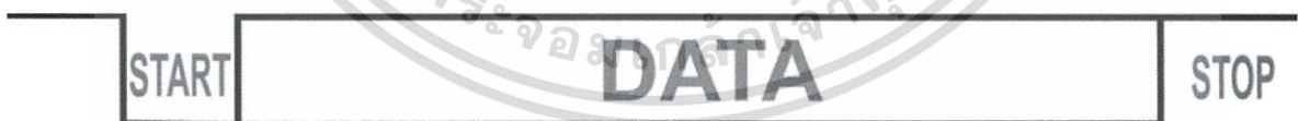
รูปที่ 2.15 การสื่อสารอนุกรมแบบ Asynchronous
