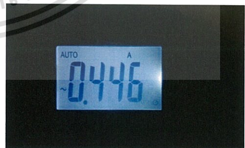
รูปที่ 4.26 วัตกระแสไฟฟ้าของหลอดไส้
