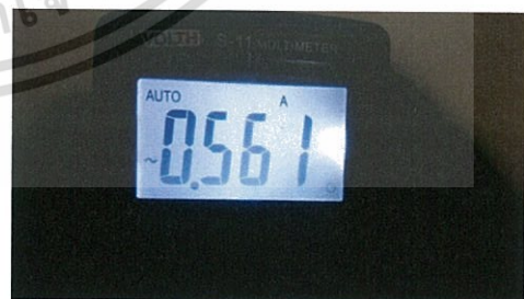
รูปที่ 4.22 วัดกระแสไฟฟ้า ที่กำลังไฟ 130 วัตต์
