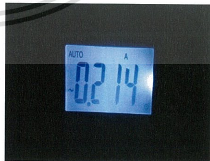
รูปที่ 4.17 วัดกระแสไฟฟ้าของพัดลม
