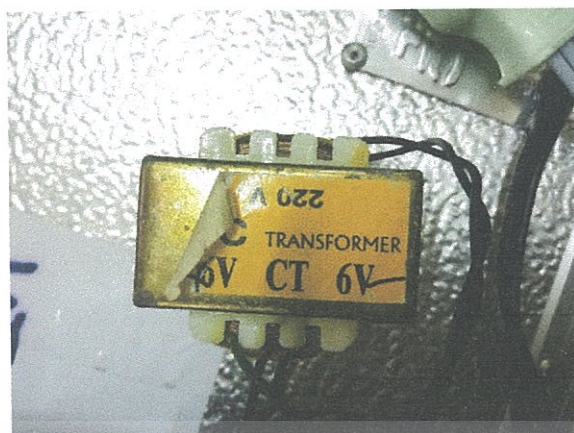
รูปที่ 3. 4 หม้อแปลงไฟฟ้าจาก 220 V เป็น 6 V
