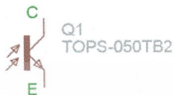
รูปที่ 2.21 แสดงสัญลักษณ์ของโฟโต้ทรานซิสเตอร์ [6]
