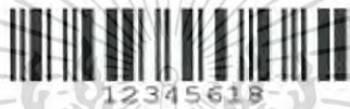
รูปที่ 2.21 บาร์โค้ดแบบแท่งชนิด Interleaved 2 of 5 [9]
