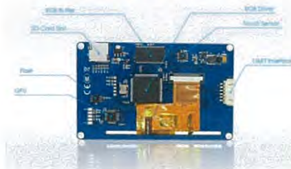
รูปที่ 2.10 ส่วนประกอบบนบอร์ดของหน้าจอสัมผัส NEXTION รุ่น NX8048T043 [5]
