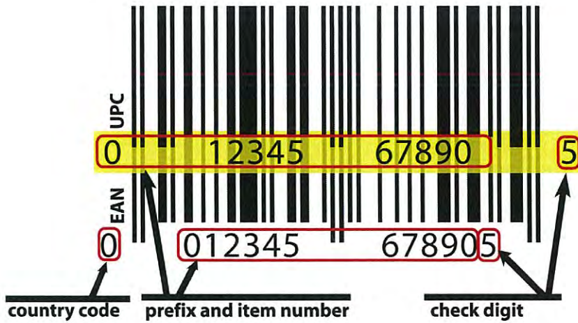
รูปที่ 2.26 ความหมายของแถบบาร์โค้ด EAN-13 แถบต่างๆ [9]
