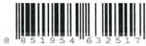
รูปที่ 2.17 บาร์โค้ดแบบแท่งชนิดยูพีซี/อีเอเอ็น [9]
