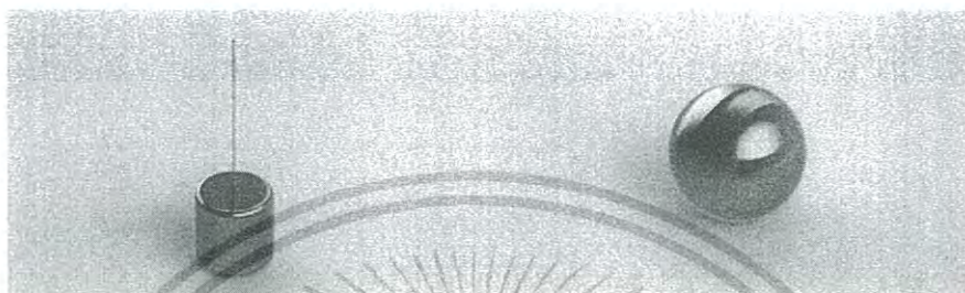
รูปที่ 3.9 แบบจำลองอิเล็กโตรดชุดทดสอบค่าความคงทนต่อแรงดันอิมพัลส์ฟ้าผ่าของฉนวนเหลว
