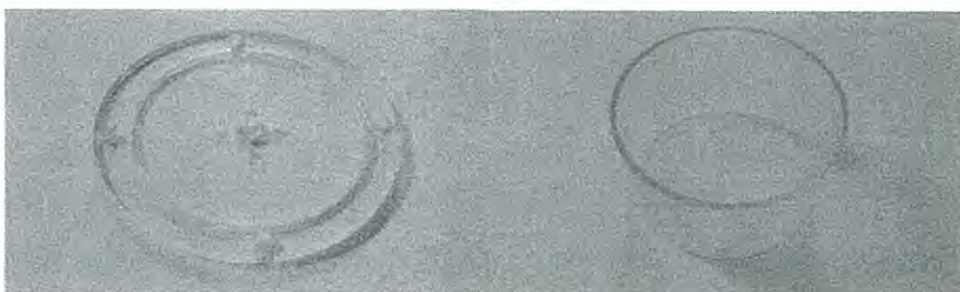
รูปที่ 3.2 ที่บรรจุน้ำมันและใส่เพรสบอร์ดชุดทดสอบค่าความคงทนต่อแรงดันกระแสสลับของเพรสบอร์ดที่ออกแบบสร้างจริง
